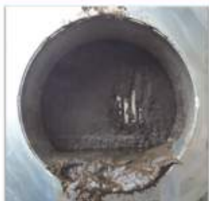
粉塵による熱交換器の閉塞
