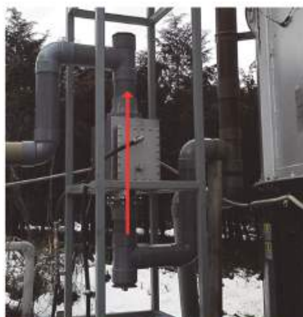
結露水によるプレートフィン閉塞対策
