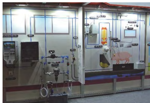
写真 2.2 環境制御装置
